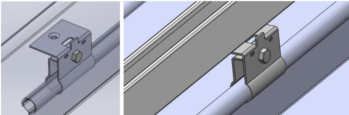
Fixation des rails A52 à l'aide des pinces OPTIMA au droit des pattes de fixation composite du bac sur l'écarteur.
